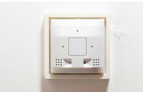
*Moderne Sicherheitssensoren fallen kaum auf. Sie lassen sich z. B. in Lichtschalter integrieren.*
